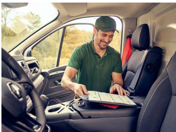
Dossier du siège central rabattable offrant une tablette de travail stable et pratique
